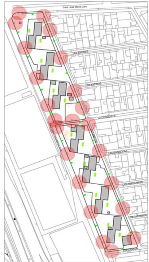
Luminarias Existentes en Funcionamiento
